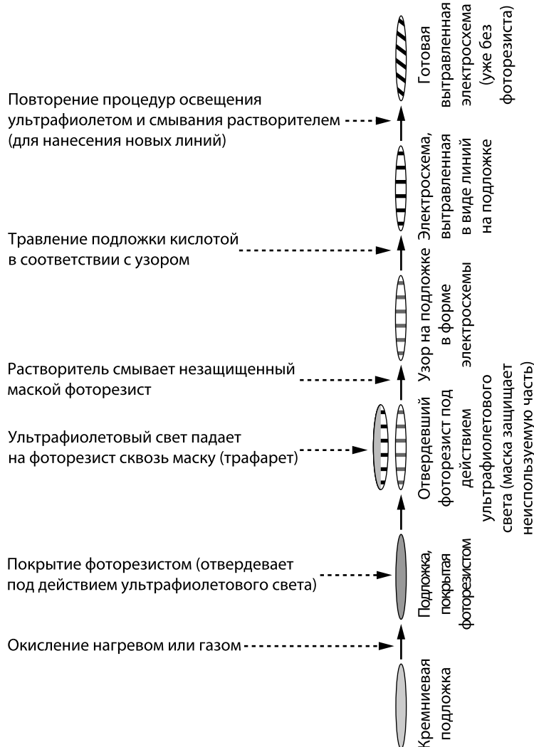
Рис. 9.2. Создание микрочипа с помощью литографии
