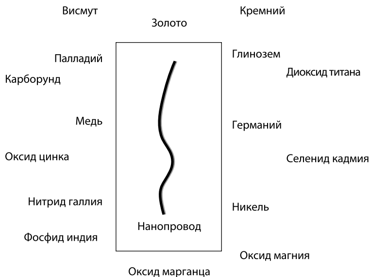
Рис. 9.4. Нанопровода можно создавать из разных материалов
