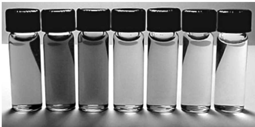
Рис. 6.10. Оттенки света, поглощенного нанооболочками разного размера (публикуется с разрешения Дженифер Уэст)
